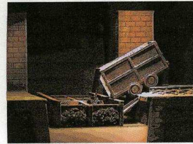
Figura 1 Sistema de carga de las barcas en el muelle interior del canal. Maqueta Centro de Interpretación de la Minería, Barruelo
